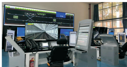
As型地铁车辆仿真驾驶实训室
